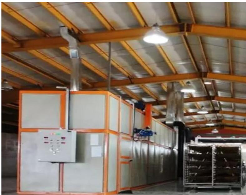
Сушка фруктов путем использования отработанного тепла, вырабатываемого системой ТЭЦ (комбинированное производство тепла и электричества), является новым методом в стране. Эта новаторская инициатива включает в себя приверженность энергоэффективности, сокращению выбросов парниковых газов и оптимизации ресурсов.
